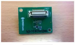
Figure 4 Sensor module
