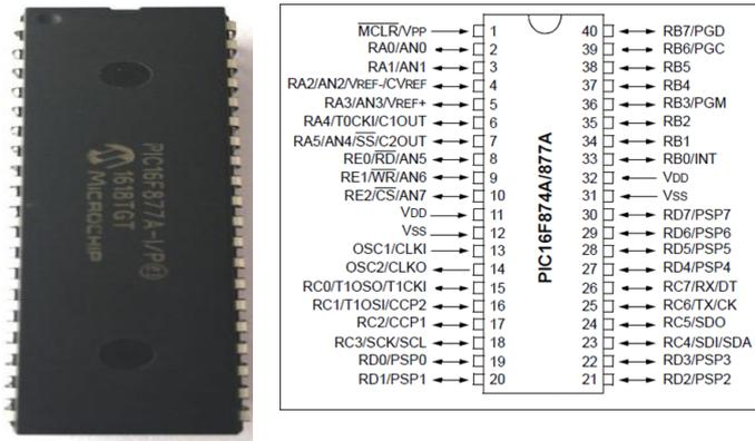
Fig. 3.2: PIC16F877A Microcontroller & 3.2b. Pin Diagram
