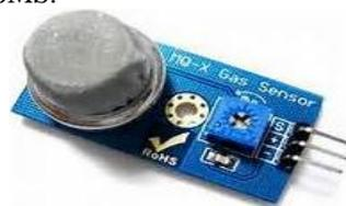
Fig. 3.2: MQ-2 Sensor
